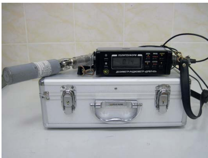
Рисунок 3 – Дозиметр-радиометр ДРБП-03 с блоками БДГ-01 и БДБА-02.
