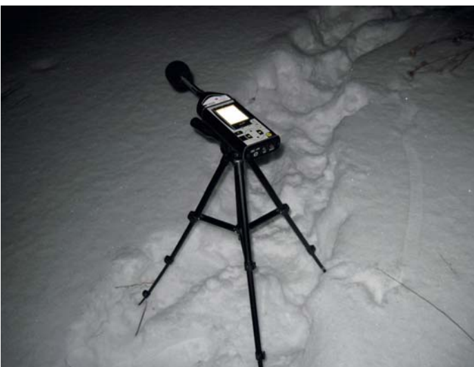
Рисунок 5 – Расположение шумомера-анализатора спектра «Экофизика-110А» при проведении измерений на селитебной территории в ночной период суток.
