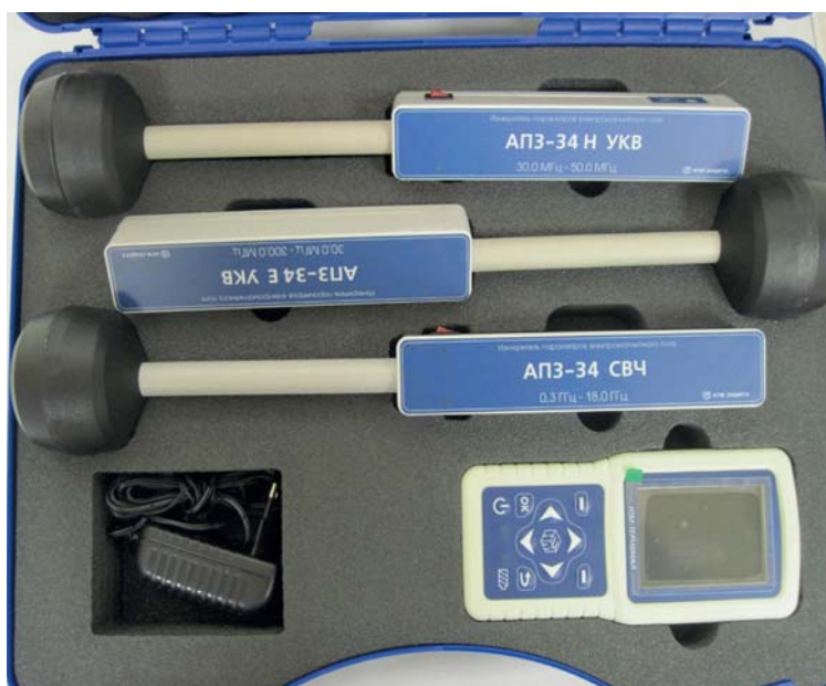
Рисунок 1 – Измеритель параметров электромагнитного поля ПЗ-34, работающий по беспроводному принципу, с 3 антеннами-преобразователями.
