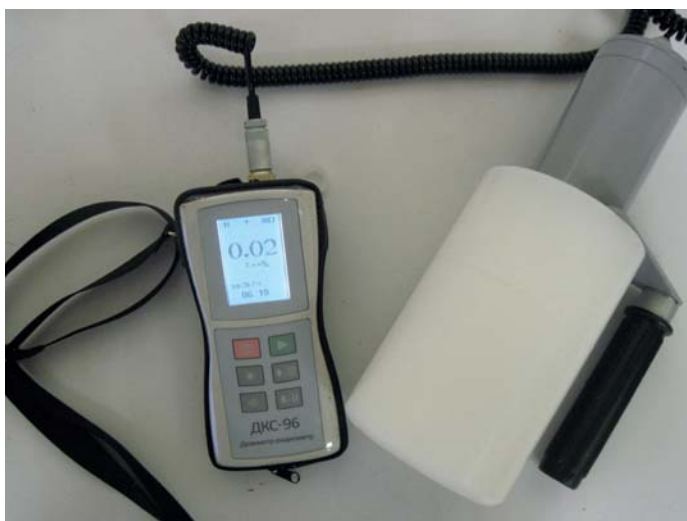
Рисунок 4 – Дозиметр-радиометр ДКС-96 с блоком детектирования нейтронного излучения БДМН-96.
